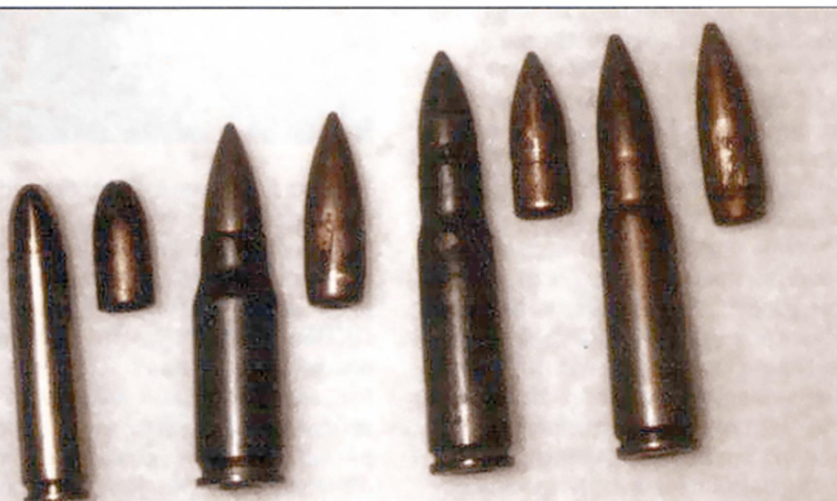
Внешние очертания пуль: .30 Carbine, пуля со свинцовыми сердечником; 7,92x33 Курц, пуля со стальным сердечником; 7,62x41 (ранний вариант патрона обр. 43 г.), пуля со свинцовыми сердечником; 7,62x39 обр. 43 г., пуля со стальным сердечником
